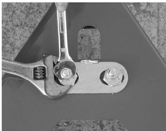
Fig.2 Låsplattans justering hos standard- och Heavy Duty A-ramarna.
