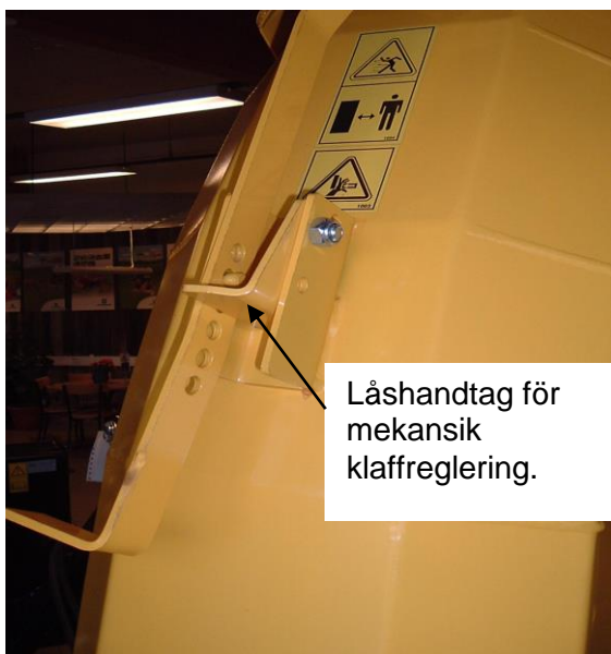
Mekanisk klaffreglering (Std)
