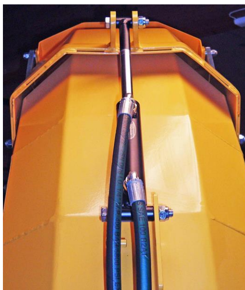
Hydraulisk klaffreglering (Tillval)
