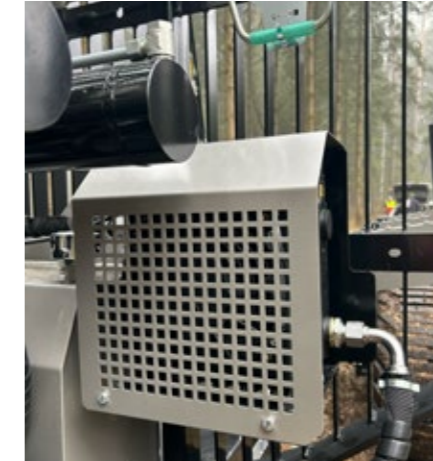
Ölkühler Der elektrische Ölkühler beugt thermischen Problemen an langen Arbeitstagen nicht nur im Sommer vor.
