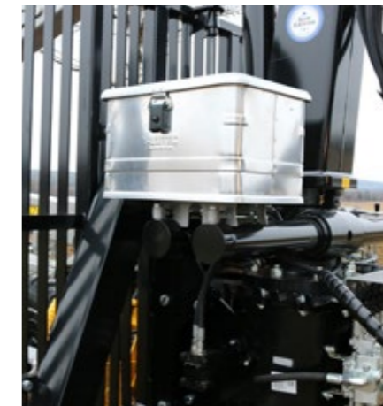
Werkzeugkasten Robuste Aluminiumbox, gut geschützt hinter dem Gitter platziert; 400x300x245 mm.
