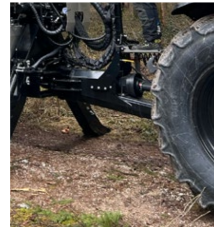
Pumpe geschützt verbaut (MF1202TEC) Hochwertige Gusspumpen für komfortables Arbeiten mit Eigenhydraulik. Oben- oder Untenanhängung auch nachträglich drehbar.
