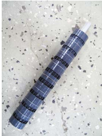
kuva 6B, vakio Kylvöakseli, jossa pieni siemensyöttin jokaiselle suuttimelle.
