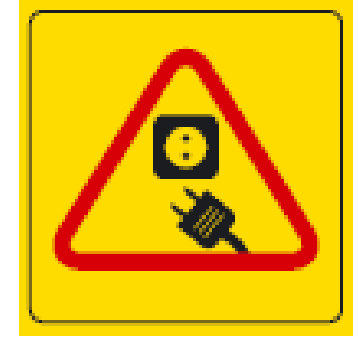
Koppla från maskinens strömtillförsel före serviceåtgärder
