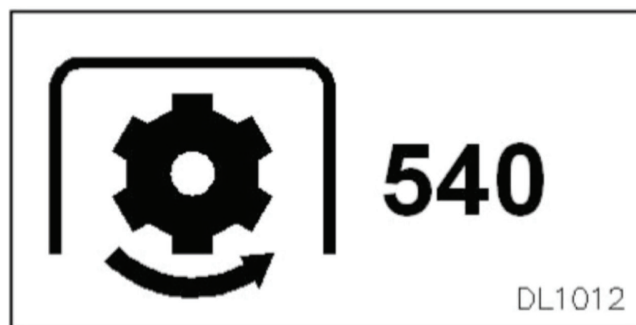
Kraftöverföringsaxelns rotationsriktning och varvtal – modellspecifikt
