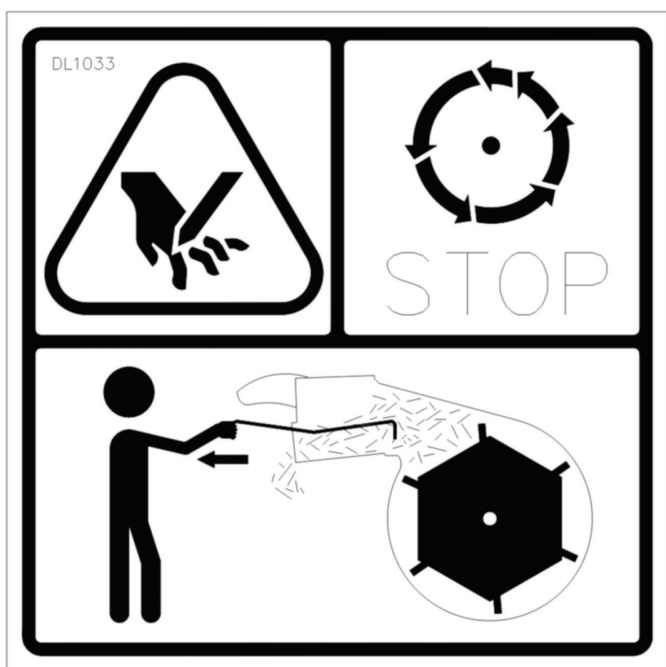
Låt rotorn stanna innan blockeringar tas bort med det medföljande verktyget
