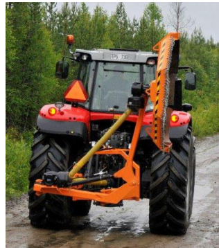
Dra in sidoförskjutningen så att transportbredden minimeras.
