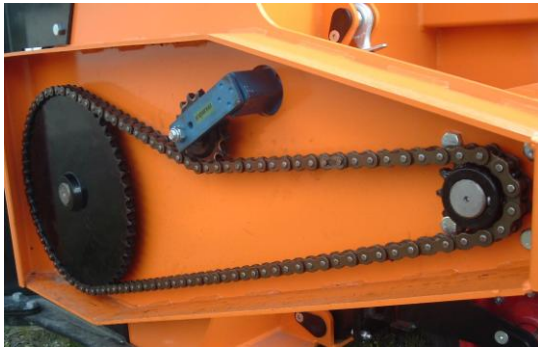
Kedjedrivning av inmatningsskruv med spänningsanordning av torsionstyp
