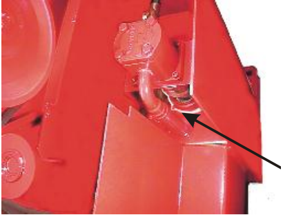
Lagren på hydraul- pumpens drivaxel.
