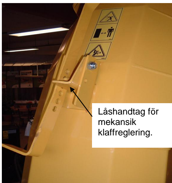
Mekanisk klaffreglering (Std)
