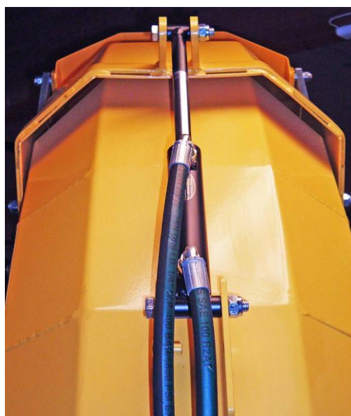
Hydraulisk klaffreglering (Tillval)
