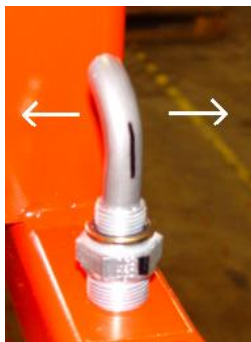
1.2a OBS Röret kan vridas i nippeln.
