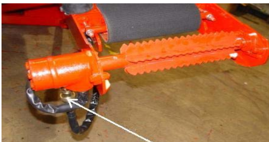
1.3.a.4 Returanslutningen försedd med en snabbkoppling
