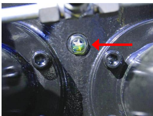
Nivåglas för vridhus. Oljenivån skall täcka halva nivåglaset.
