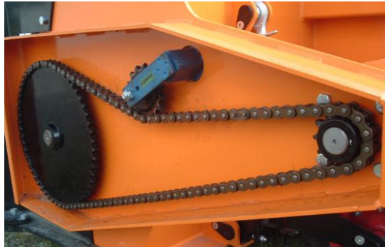
Kettenantrieb der Einfuhrschnecke mit Kettenspanner (Torsionstyp)
