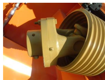
Scherbolzen Gelenkwelle M10x70 8,8
