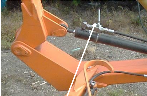
Transportsicherungsventil des Hubzylinders in der Transportstellung.
