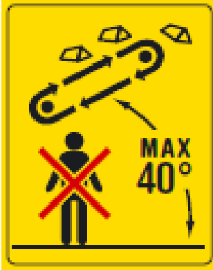
Transportörens maximala driftvinkel är 40° Gå inte under transportören
