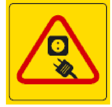
Koppla från maskinens strömtillförsel före serviceåtgärder
