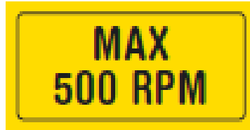
Max. varvtal för kraftöverföringsaxeln är 500 r/min
