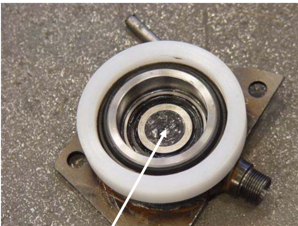
Bild 20102c Fyll navet på trycklagret med fett enligt bilden
