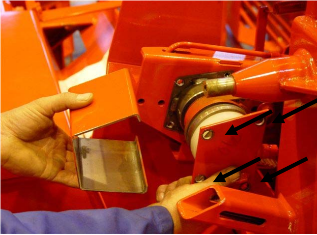
Bild 20102a Lossa kopplingens 4 insexskruvar och lossa kopplingsskyddet samt trycklagerenheten
