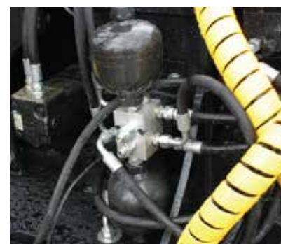
Kuormain- ja kääntövaimennin Säästä kuormaimen osia vaimentamalla. Tekee kuorman lastauksesta ja purkamisesta joustavaa ja pehmentää liikekuviota.
