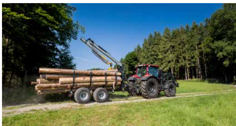
EHC - Ohjaussauvaohjaus Sähköiset proportionaaliventtiilit tarkoittavat, että hydraulipaketti on sijoitettu perävaunuun. Kuormainta ohjataan ergonomisilla ohjaussauvoilla. Voidaan myös täydentää erilaisilla vipukiinnikkeillä.
