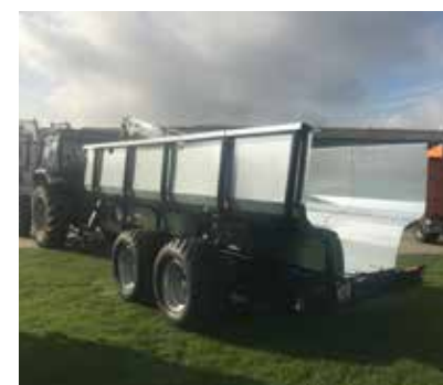
Biomassalaatikko Kuormausalueen sisällä oleva laatikko suojaa kadut ja tiet oksilta ja roskilta kuljetuksen aikana. Valmistettu sinkitystä levystä, saatavana malleihin MF850, MF950 ja MF1050.
