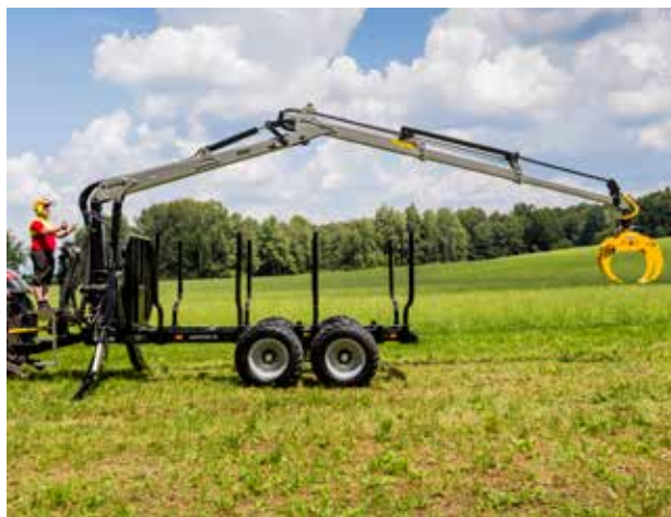
S-Line-kuormaimilla ulottuu pidemmälle. Moderni rakenne ja kaksoisteleskooppi helpottavat työpäivää, ja rakenteen kaikki materiaalit ovat huippulaatua. Valmistuksessa käytetään ainoastaan SSAB:n erikoisterästä.
