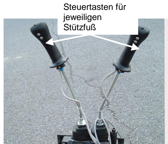
Leichtgewichtspaket mit Betätigungshebel für Kran und Stützfüße.
