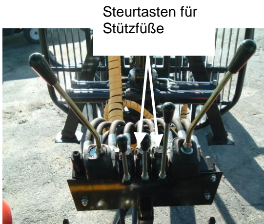
Standardpaket mit Betätigungshebel für Kran und Stützfüße.
