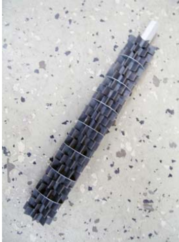
fig.6A, std Såaxel med stora frömatare
