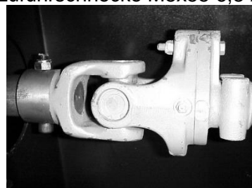
Scherbolzen Zuführschnecke M8x55 6,8 Art.-Nr. 970813
