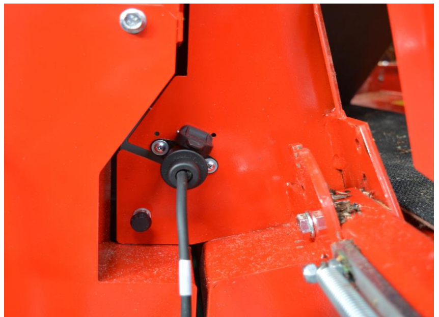
Bild 14. Elektrisk kontakt på den elektriska styrenheten
