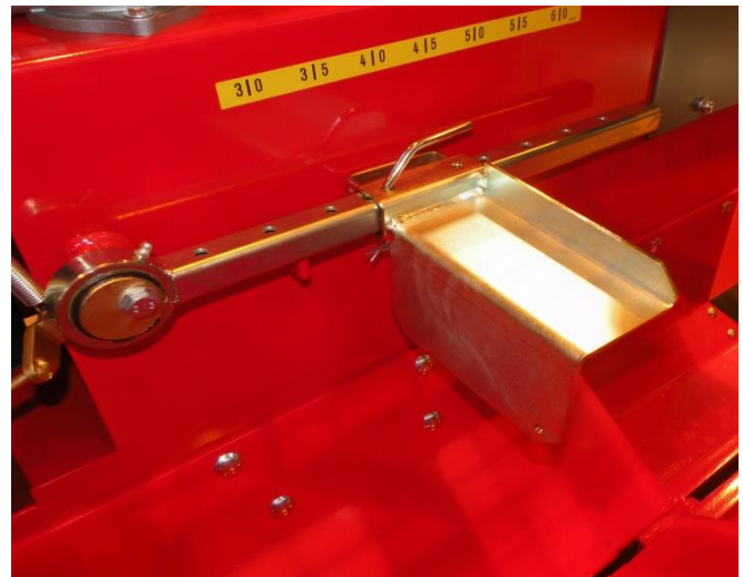
Bild 18. Begränsningsplattans läge för små stockar
