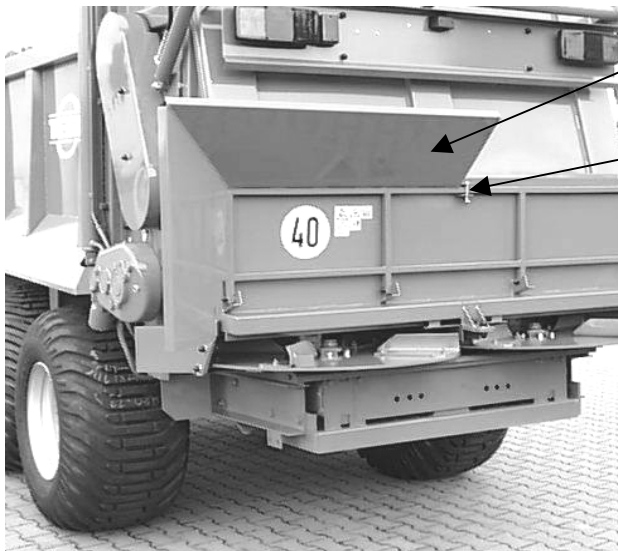
Spridningsbegränsaren är lyft
