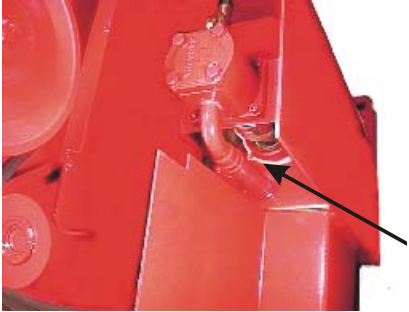
Lagren på hydraul- pumpens drivaxel.
