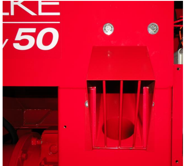
4. Avlägsna spånskivan och montera skyddsgallret på plats enligt bilden.
