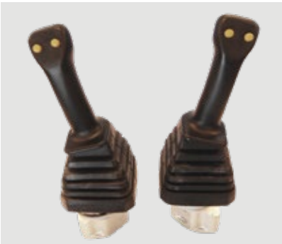
Commande basse pression PCL Commande proportionnelle avec 2 fonctions XY (PCL) et 4 fonctions électriques actionnées par bouton-poussoir sur les leviers.
