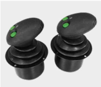
Joystick EHC 2 fonctions XY, ainsi que deux fonctions proportionnelles actionnées par sélecteur rotatif à l'avant du joystick, ainsi que deux fonctions marche/arrêt (stabilisateurs, faciles à programmer, avec compensation de température (huile froide/chaude)).
