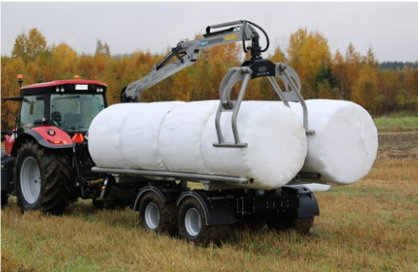
Plateforme à balles rondes Pour le transport de 11 balles maximum sur votre MF1202, le grappin G130 peut être équipé d'un dispositif de préhension à balles.
