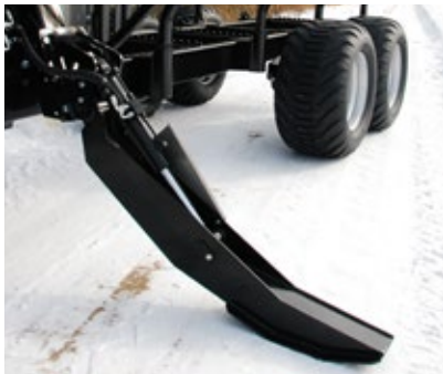
Pieds de support pliables Disponible en accessoire pour MF650 et MF1602. Requis pour le montage de la grue.
