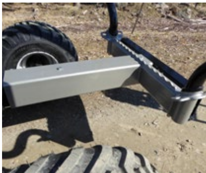
Rallonge de châssis Cette extension du châssis comprend un rancher à montants.
