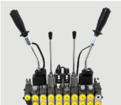
Commande électromécanique 2 fonctions XY plus deux fonctions électriques avec interrupteurs à bascule sur les leviers, ainsi que deux fonctions mécaniques distinctes (stabilisateurs).
