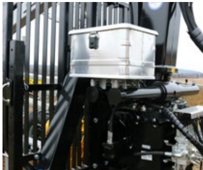
Boîte à outils Boîte en aluminium robuste, bien protégée derrière la grille; 400x300x245 mm.
