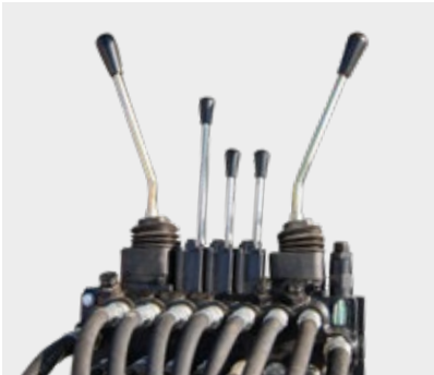
Commandes mécaniques Fonctions 2XY plus 3 ou 4 sections individuelles.
