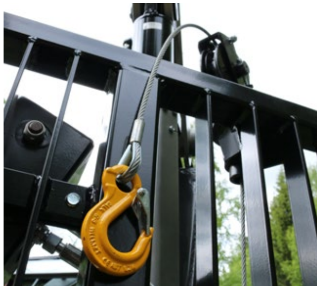
Treuil radio hydraulique avec poulie de guidage Pour des raisons de sécurité, le treuil est monté sous la grue. Il en résulte une stabilité supérieure de la remorque et une meilleure capacité de levage de la grue. Pour étendre l'angle de traction, une poulie peut être montée sur la grue. La force de traction du treuil est de 1 700 kg avec un câble de 40 m sur le tambour. La longueur maximale du câble du système radiocommandé standard est de 60 m.
