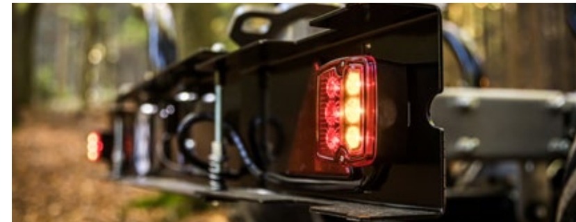
Rampe d'éclairage, rétractable La rampe lumineuse rétractable est disponible en accessoire (commande d'usine). Sa fonction rétractable permet de la protéger pendant le travail forestier.
