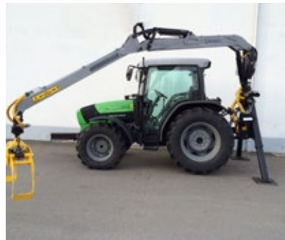
Trépied À monter directement sur l'attelage trois-points du tracteur (bras de levage). Différentes tailles proposées en fonction du format et du modèle de grue, par exemple pour fixer un outil de déchiquetage.
