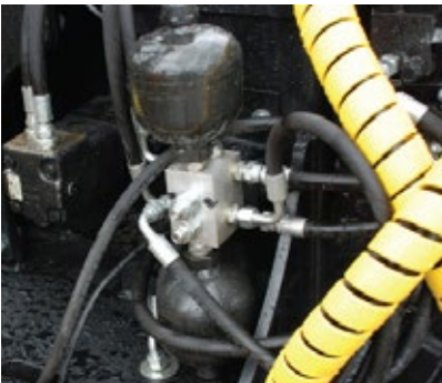
Amortissement de grue et de pivotement Ce système amortit les mouvements de charge et garantit une durée de vie prolongée de tous les composants de la grue.
