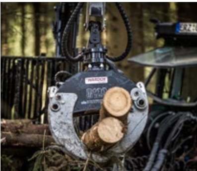
Rotateurs Trejon Multiforest propose différents rotateurs avec articulations à frein et sans frein.
