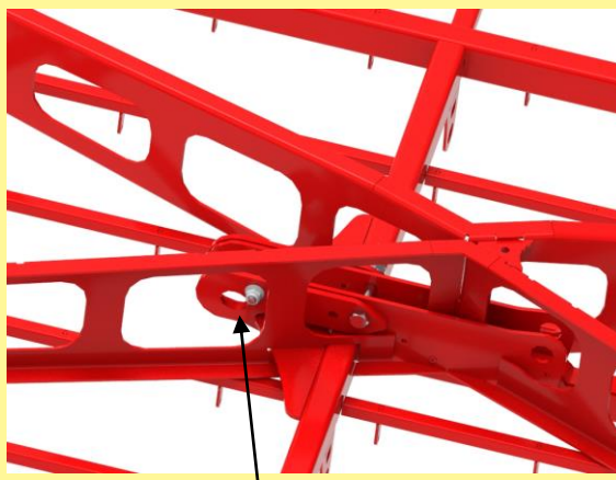
Bild 10: Fällningslåsplåt på sidoramens
