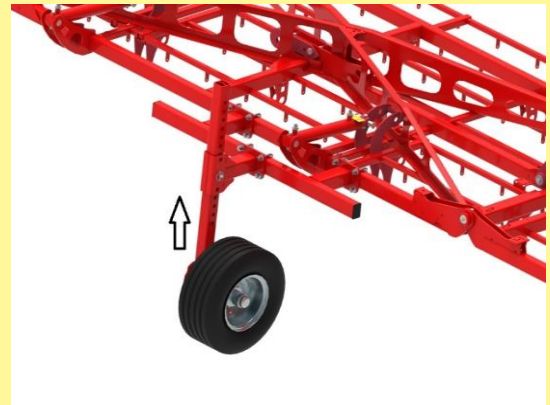
Bild 4: Fällning av den variabla harven
