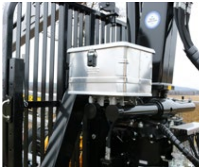
Verktöglåda Kraftig låda i Aluminium placerad väl skyddad bakom grinden. 400 x 300 x 245 mm.
