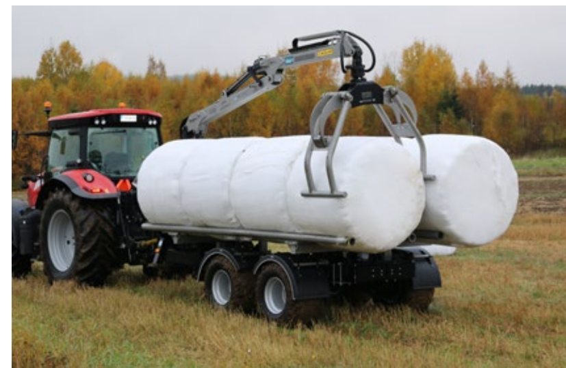
Balplattform För transport av upp till 11 balar på en MF1202. Gripen G130 kan för denna användning anpassas med en gripförlängning.
