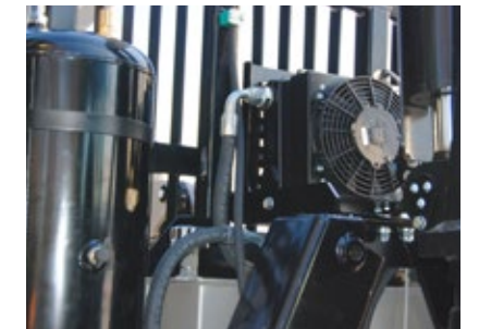
Oljekyl För kylning av olja vid kraftiga navdrifter och höglödessystem.
