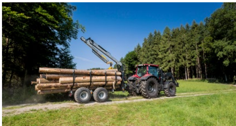
EHC - Joystickstyrning Elproportionalstyrda ventiler innebär att hydraulpaketet sitter på skogsvagnen. Kranen styrs med ergonomiska styrspakar från traktorhytten. Kan även kompletteras med olika spakfästen.
