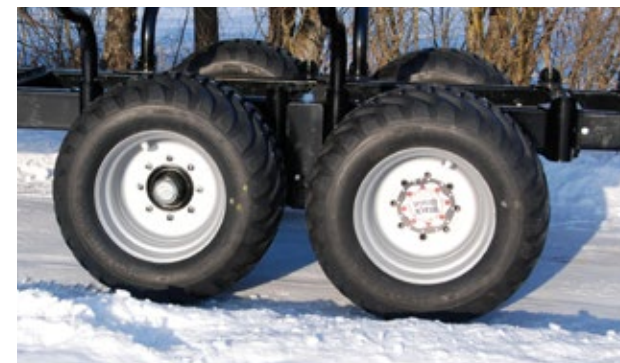
Navdrift Navdrift är ett annat vanligt tillbehör som ger vagnen ytterligare dimensioner vad det gäller framkomlighet i alla typer av förhållanden. Några av fördelarna:
