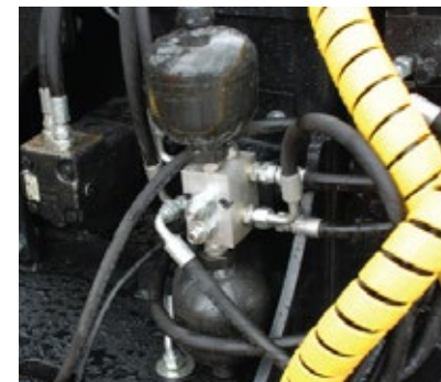
Kran- och svängdämpare Skonar kranens ingående komponenter, gör lastning och lossning smidigare och medför ett mjukare rörelseschema. Standard på S-line kranar.
