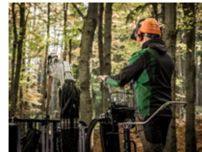
Ståplattform Utrusta ditt skogsekipage med en ståplattform för bättre sikt vid lastning och lossning.
