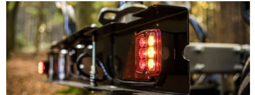
Infällbar belysningsramp Vid fabriksbeställning kan skogsvagnen utrustas med infällbar belysningsramp. Genom att fälla ihop rampen skyddas lampor vid besvärlig terräng eller när vagnen inte används.
