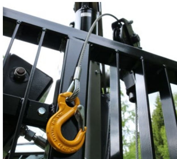
Hydraulisk radiostyrd vinsch med brytblock För ökad säkerhet sitter vinschen monterad under kranen, vilket också ger ökad vagnstabilitet och ökar kranens lyftkapacitet. För ökad dragvinkel kan ett brytblock monteras uppe på kranen. Vinschens dragkraft är hela 1 700 kg vid 40 m vajer på trumman. Maximal vajerlängd är 60 m och radiostyrning är standard.
