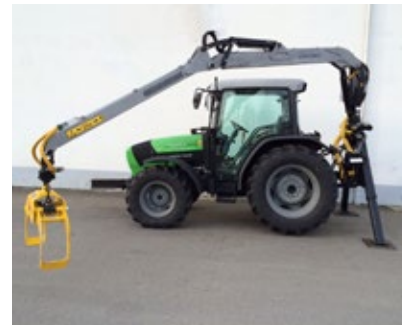
3-punktsstativ Kan montera direkt på traktorns trepunktskoppling (lyftarmarna). Tillgängliga i flera storlekar beroende på kranstorlek och modeller för till exempel montage av flistugg.
