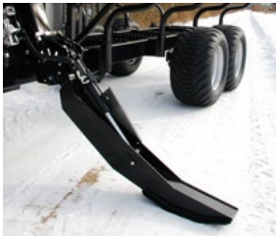
Lavettstödben Finns om tillbehör till MF650 och MF1602. Krävs för kranmontering.
