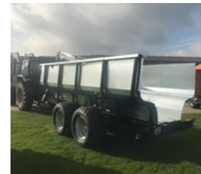
Insatsflak Insatsflak skyddar vägen från nedskräpning av kvistar och grenar under transport. Tillverkat i förzinkat plåt och finns tillgänglig till MF850, MF950 och MF1050.
