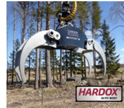
Risgrip G120E Risgripen gör det möjligt att hantera grenar/ris/energived utan att få med jord eller stenar. Mycket praktiskt vid inmatning till flistugg. Tapp Ø49,5/59,5 mm och flänsmontering, max öppning 120 cm, vikt 125 kg.
