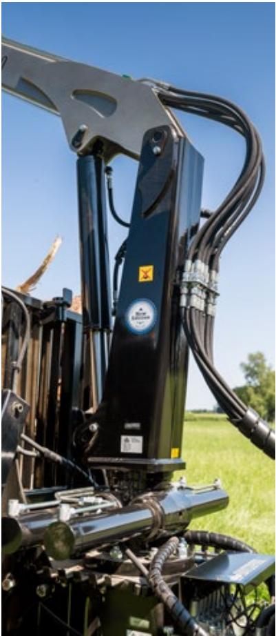
Kraftigt helgjutet vridhus och kranpelare i specialstål.
