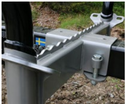
Extra banke För att underlätta skotningsarbetet kan skogsvagnarna utrustas med extra banke inklusive två stöttor.
