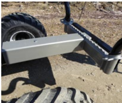
Ramförlängning Förlänger ramen och inkluderar en banke med stöttor.
