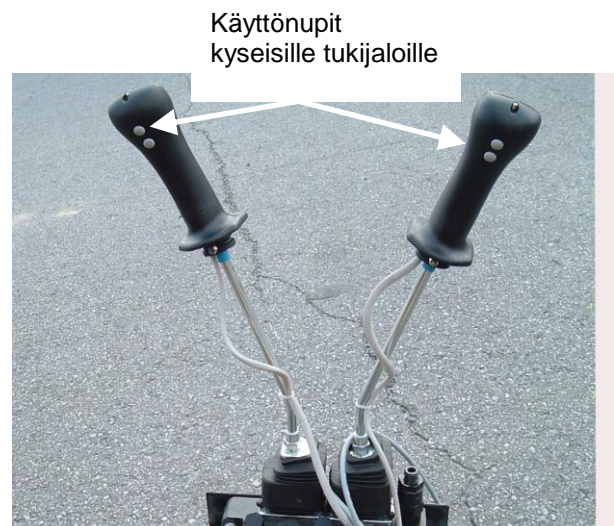
Kevytpaketti säätövipuineen nosturia ja tukijalkoja varten.
