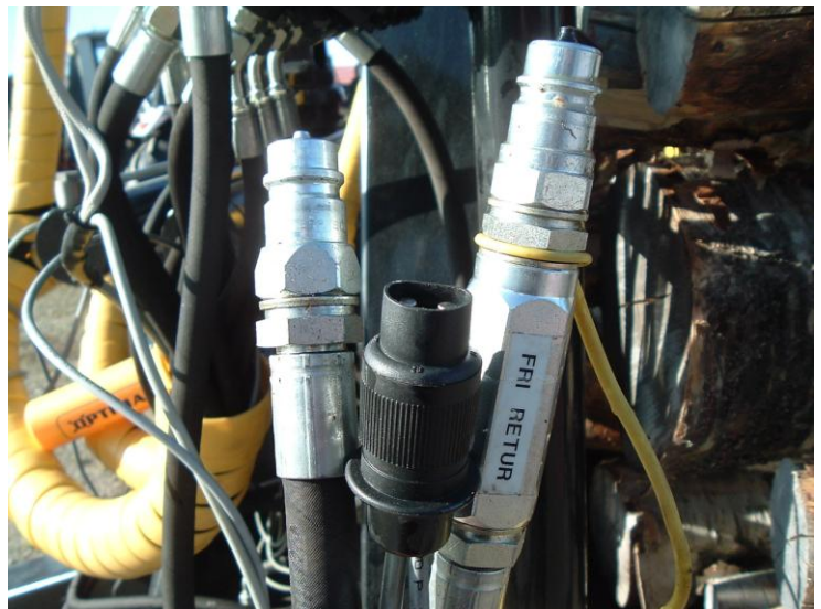
Nosturin ja tukijalkojen hydraulii- ja sähköliittimet (vaunuun, jossa on kevytpaketti).
