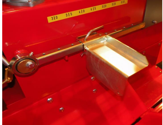
Bild 18. Begränsningsplattans läge för små stockar
