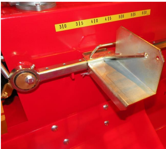
Bild 17. Begränsningsplattans läge för stora stockar på mer än 25 cm i diameter
