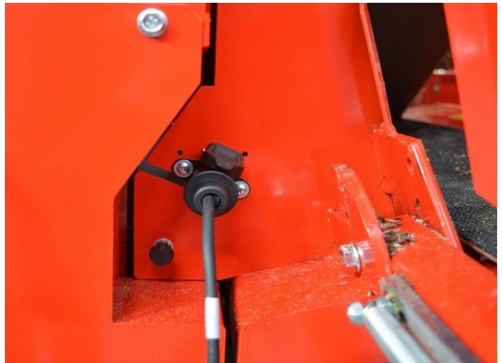
Bild 14. Elektrisk kontakt på den elektriska styrenheten
