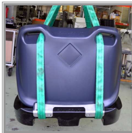
Bild 5. Lyft av fylld tank med invallningsbassäng
