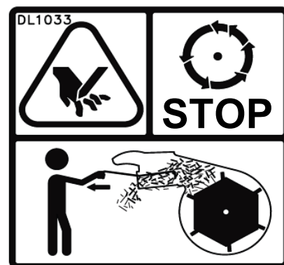
Låt rotern stanna innan blockeringen tas bort med det medföljande verktyget
