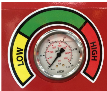
Bild 7. Tryckmätare med indikation för "lågt" och "høgt" tryck.
