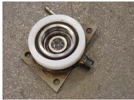
Bild 20102.4 Fyll navet på trycklagret med fett NLGI klass 2 -30°...+120° enligt bilden. Om lagret är permanentmort behövs inte denna åtgärd (Bild 20102.5).
