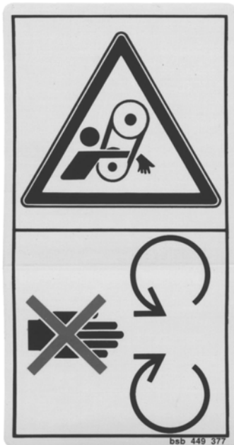
Varningsskylt "Rör ej kedjan när den är i rörelse"
