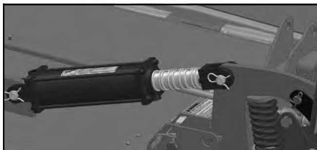
Figur 4. Transportlåsstift i driftläge
