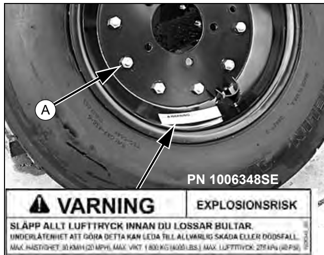
Figur 10. Däckunderhåll för delade fälgar
