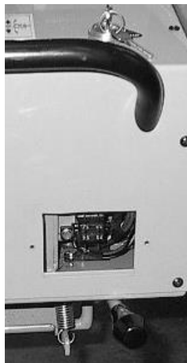
Säkringsbox på manöverpanelen
