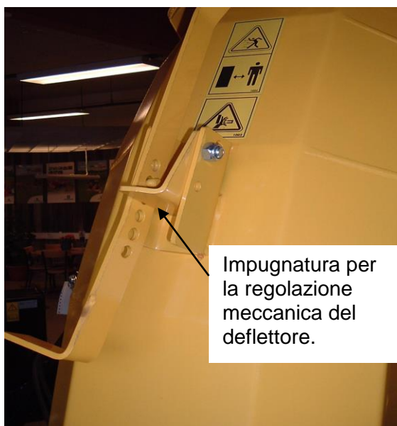
Regolazione meccanica deflettore (standard)
