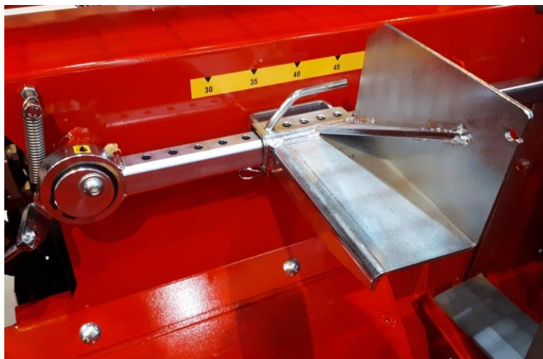
Bild 15: Mätplattans position för grov ved med en diameter på över 25 cm.
