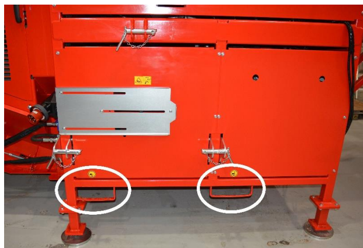
Bild 1. Maskinens lyftpunkter för truckgafflar (2 st).
