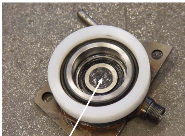
Bild 20102c Fyll navet på trycklagret NLGI Klass 2 -30°...+120° enligt bilden Om lagret är permanent smort är åtgärden Onödig (Bild 20102e)
