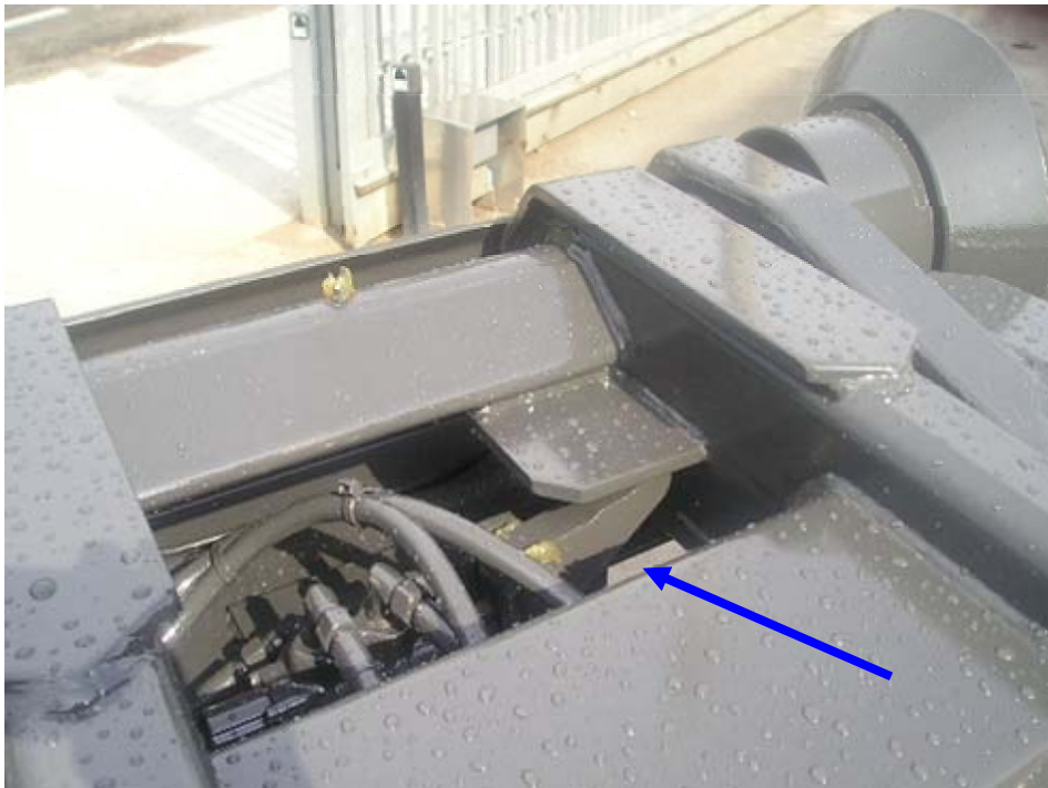
BLOCKERINGSVENTIL I STÄNGT LÄGE HYDRAULISK LÅSNING AVAKTIVERAD.
