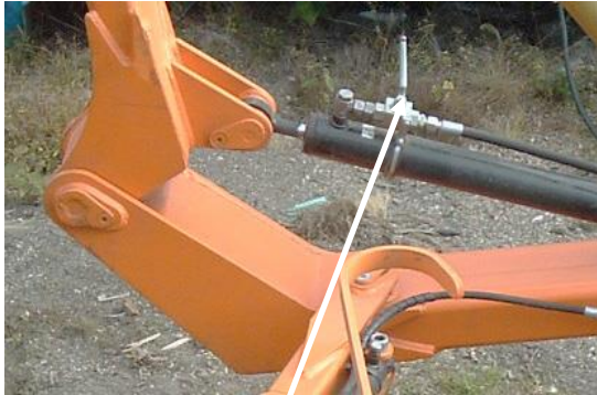
Vanne de sécurité du vérin de levage pour le transport en position de transport.
