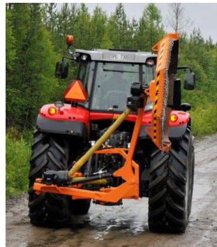
Cadre à déport latéral replié pour réduire la largeur de transport.
