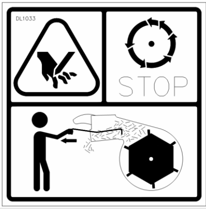
DL1033: Låt rotorn stanna innan blockeringen tas bort med det medföljande verktyget
