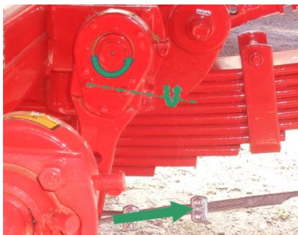
Bromsar utrustade med automatiska upptagningsarmar (40km/tim)
