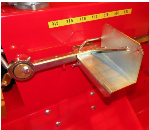
Bild 17. Begränsningsplattans läge för stora stockar på mer än 25 cm i diameter
