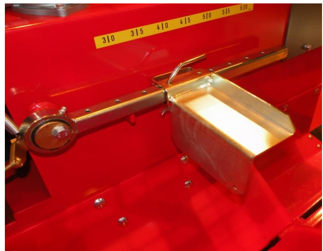
Bild 18. Begränsningsplattans läge för små stockar
