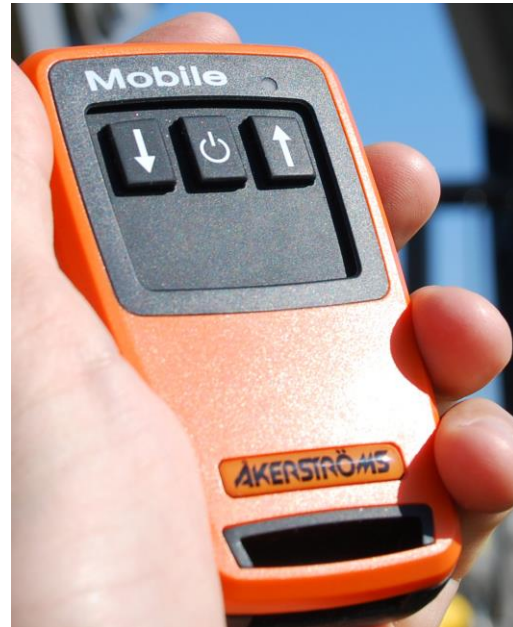
Handgerät (Funkfernbedienung) Winde mit Tasten Ein/Aus, Ein-/Ausfahren
