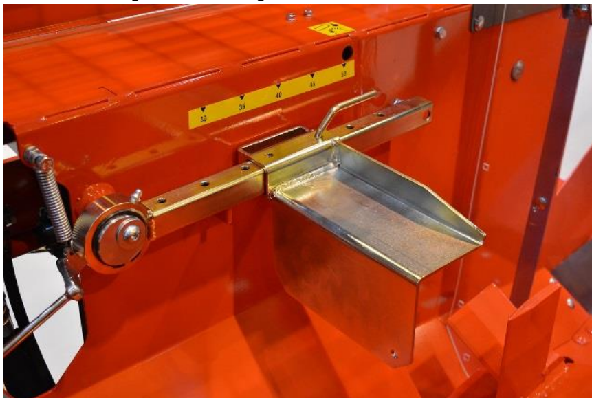
Bild 19. Mätplattans läge för mindre ved.
