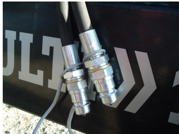
Raccordements hydrauliques pour la commande du châssis
