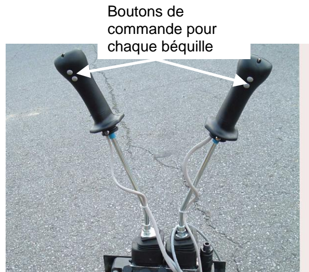
Distributeur léger avec joysticks pour la grue et les béquilles.
