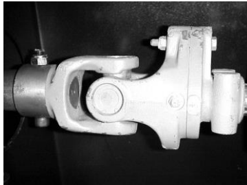
Scherbolzen Räumschnecke M8x55 6,8
