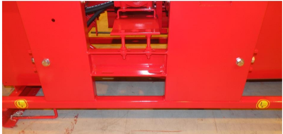
Bild 2. Maskinens lyftpunkter för truckgafflar.
